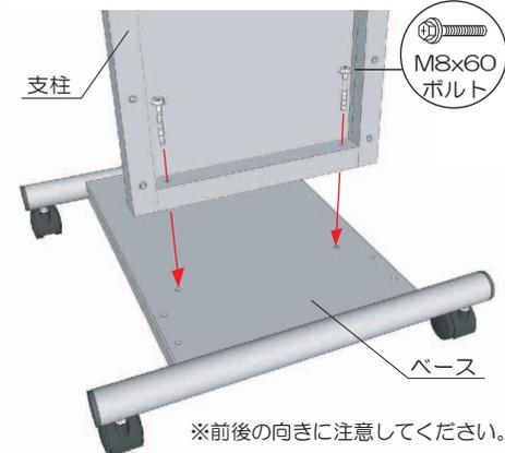
・補強金具を取付します。(左右4箇所)
