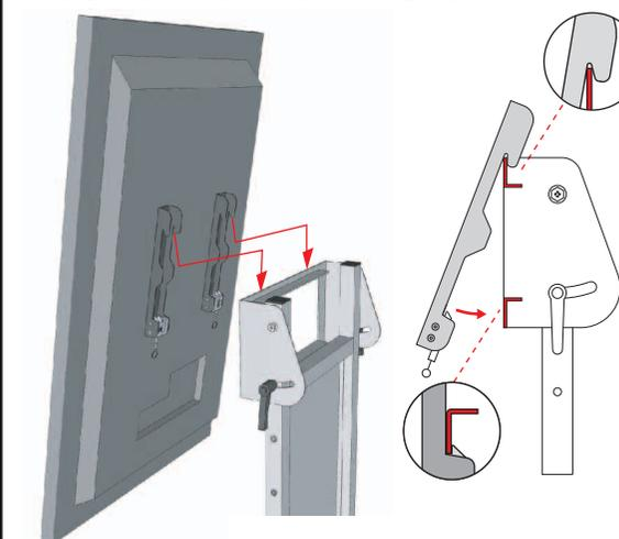
ディスプレイを持ち上げて、取付金具上部のツメをブラケットのレールに引っかけてください。取付金具上部を引っかけたら押し当てて下部のツメでロックしてください。
